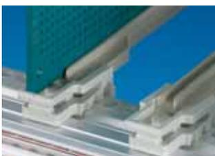
Der zweiteilige Kartenzieher dient dem Sichern und Herausziehen von Leiterplatten ohne Frontplatten. Das Unterteil kann auch einzeln nur als Kartensicherung eingesetzt werden.
