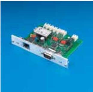
Überwachung der Systemspannungen, PSU-Status, RiCool Alarm und Weiterleitung der Meldungen vom Temperatur- und/oder Lüfter-Modul mit Hilfe der RS232- (zu PC) oder RS422-Schnittstelle (zu CMC-TC).
