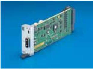
Das PM ist ein 355 W MicroTCA PowerModul im Advanced Mezzanine Card (AMC) Formfaktor single/Full-size kompatibel zur MTCA.0 Spezifikation. Das PowerModul beinhaltet einen Enhanced Module Management Controller (EMMC), der mit dem Carrier Manager über Intelligent Platform Management Bus (IPMB) kommuniziert.
