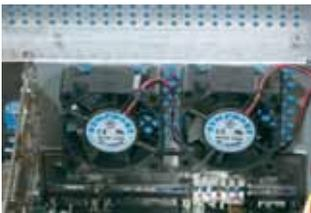
Lüfter 12 V DC, 60 mm, für die Montage auf die Rückwand. Inklusive 2 x 4-poligen Steckern mit Anschluss.
