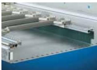
Für die gezielte Luftführung im Baugruppenträger. Die Schottwände werden zusammen mit den Busplatinen an die Verbindungsschienen geschraubt
