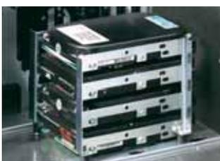
Die Laufwerkhalter dienen der Aufnahme von zusätzlich max. 4 Festplatten 3 1/2". Sie werden im Gehäuse hinter dem Lüfter montiert.
