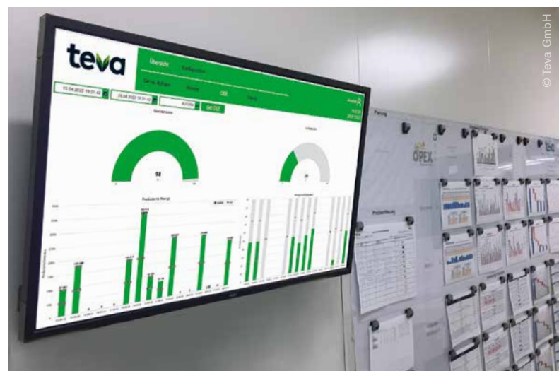
Verbesserung der Fertigungssteuerung durch die digitale Anzeige der Overall Equipment Effectiveness, im Vergleich zur vorherigen Methode (©TEVA)
