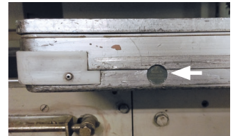
Transportbehälter-Basis mit eingebautem RFID-Transponder
